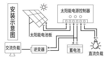
●接控制器时,一定要先接蓄电池,再接光伏板。
